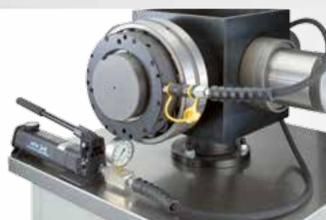
Montage auf Spannhülse mit Hydraulikmutter.
