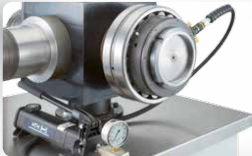
Extraktion der Klemmhülse mit Hilfe der Hydraulikmutter
