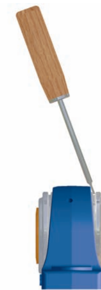
Demontage der Schutzkappen
